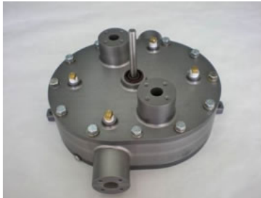
写真1:ロータリー熱エンジン試作モデル(ロータリー部分)
