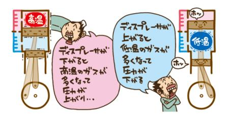
ただし、ディスプレーサの上と下には圧力のちがいはないので、このままではディスプレーサに縦方向の動きは起こらない。そこで重要な役目をするのが、シャフトによってつながれているパワーピストンだ。
