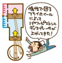
フライホイールが惰性で回転することによって、パワーピストンが上方向へ押し戻される。それにともない、シャフトでつながれたディスプレーサも上方向へと移動する。
