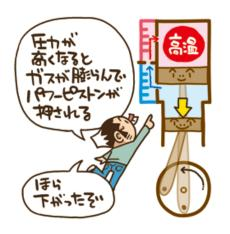
ディスプレーサに押された冷却側のガスが加熱側に流れ込むと、シリンダー内の圧力は上がっていく。それにともなって、中のガスが膨らもうとしてパワーピストンが下方向に押される。
