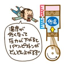
この行程を繰り返すことで、パワーピストンとディスプレーサは 上下動し続け、フライホイールは回転を持続する。これがスター リングエンジンのしくみである。そして、フライホイールの部分 に磁石とコイルを仕込めば、そこに電気が生まれるというわけ だ。
