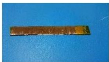
磁歪薄帯にコイルを巻いた発電素子
